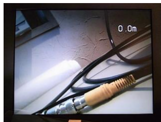
明るい室内 (LED OFF) 手前のコネクターまで 12cm 奥の壁まで 40cm
