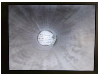
LED 照明:暗いパイプの内面 S U S パイプ 内径 33mm 長さ 20cm
