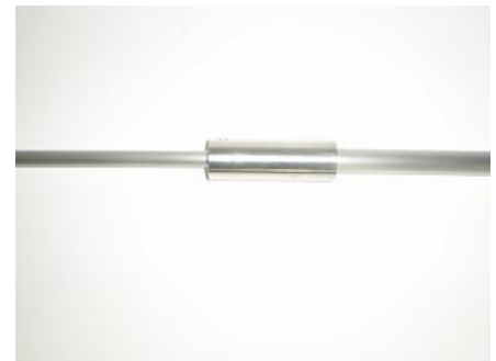
繋いだ部分（ネジで固定）
